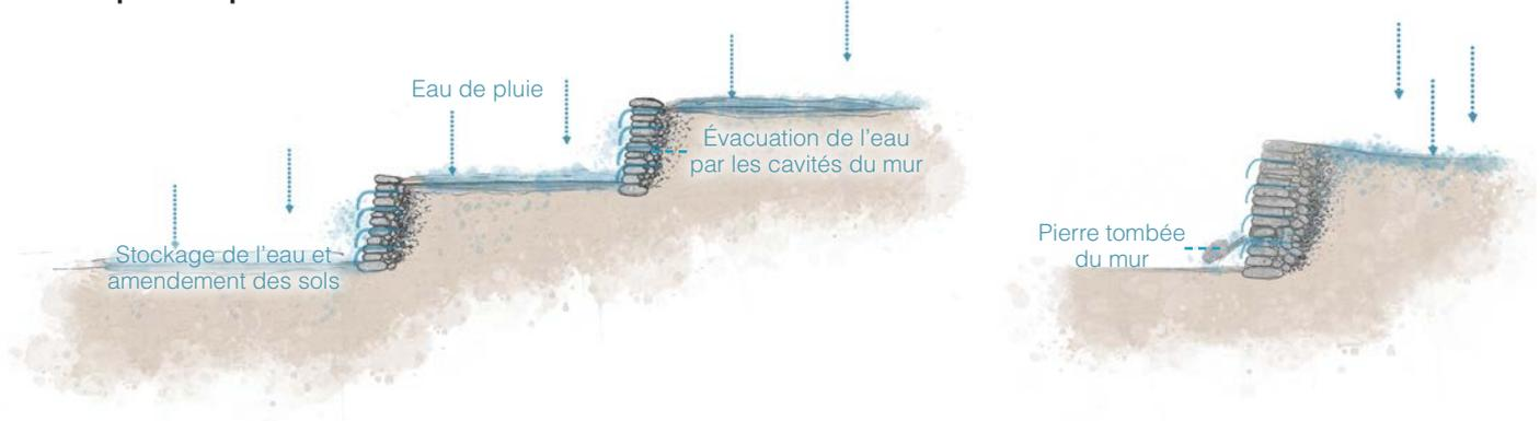
Stockage et évacuation de l'eau sur des restanques en pierres sèches
